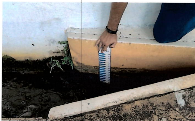
Foto 8: Régua medidor de vazão Calha Parshall.
