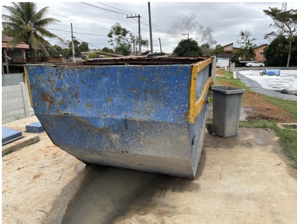
Foto 12 – Caçamba para recolhimento de sólidos grosseiros
