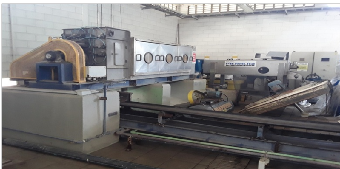
Foto 17- Filtro de desaguamento contínuo – Contpress.
