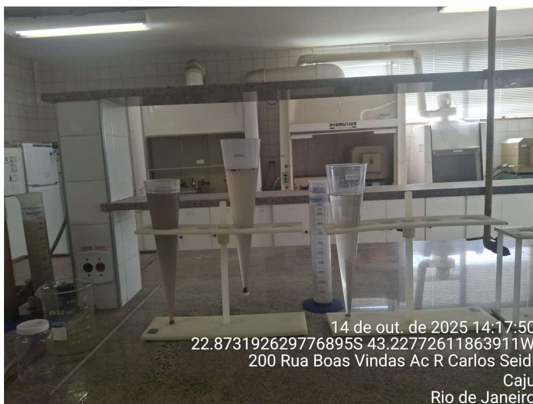
Foto 69 – Amostra à esquerda: Entrada de chorume (1%). Amostra do meio: Entrada do efluente. Amostra à direita: Saída do efluente.
