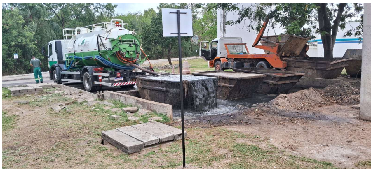
Foto 67: Momento do recebimento do líquido proveniente de fossas sépticas, com evidências de dispersão para o entorno da caixa de contenção.
