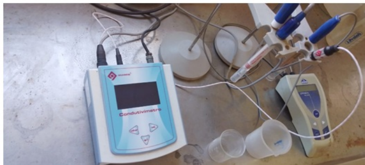
Foto 9 e 10 - Amostra do esgoto bruto/sedimentado/tratado ; Medidores para controle do processo.
