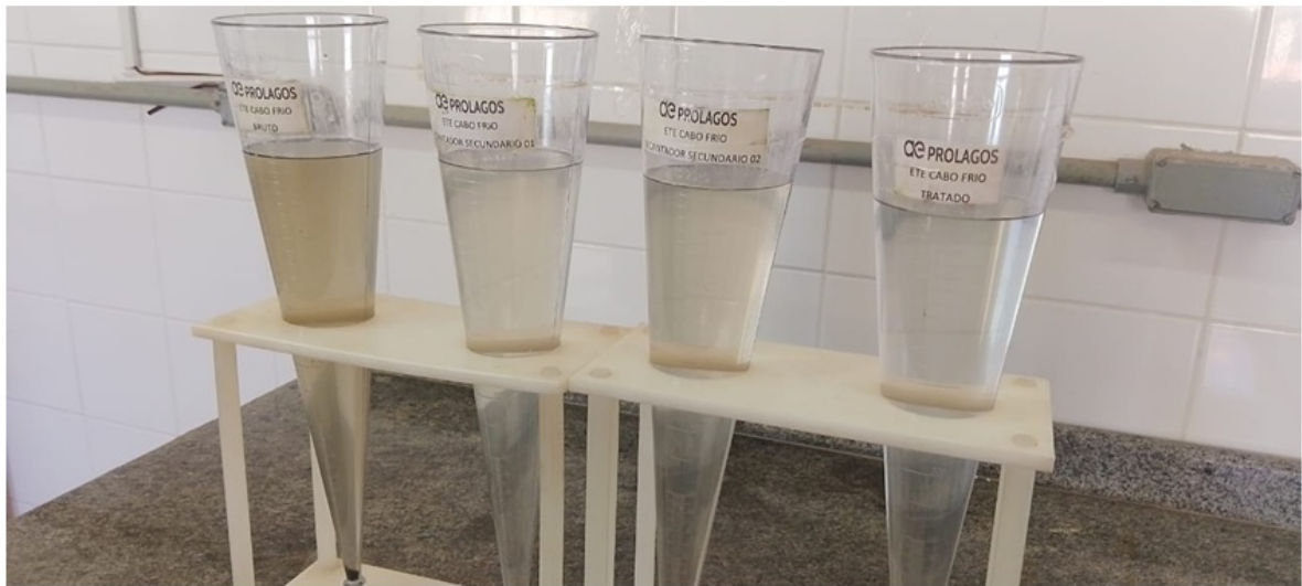
Foto 7 e 8 - Dosagem de PAC para formação de flocos ; Decantador onde os flocos sedimentam e são removidos.
