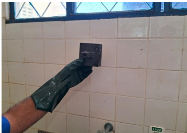
Foto 22: operador realizando ensaio de determinação da dosagem de CRL por comparação visual. Destaca-se que o uso de colorímetro digital traria mais precisão e menos interferências na medição.
