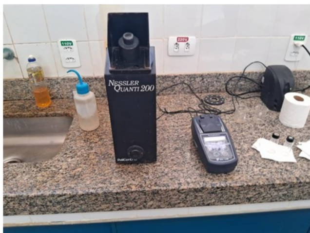
Foto 21: Medidores de cor e turbidez do laboratório da ETA.
