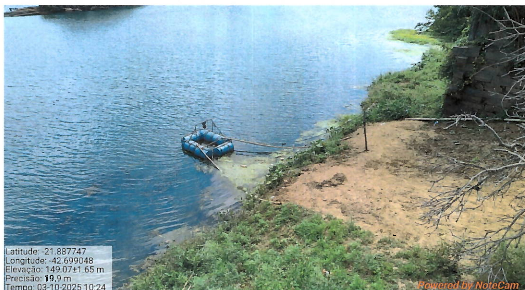
Foto 4: Balsa equipada com bomba submersível.
