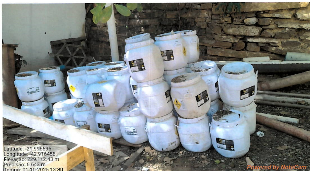
Foto 21: Armazenamento inadequado de hipoclorito de cálcio.
