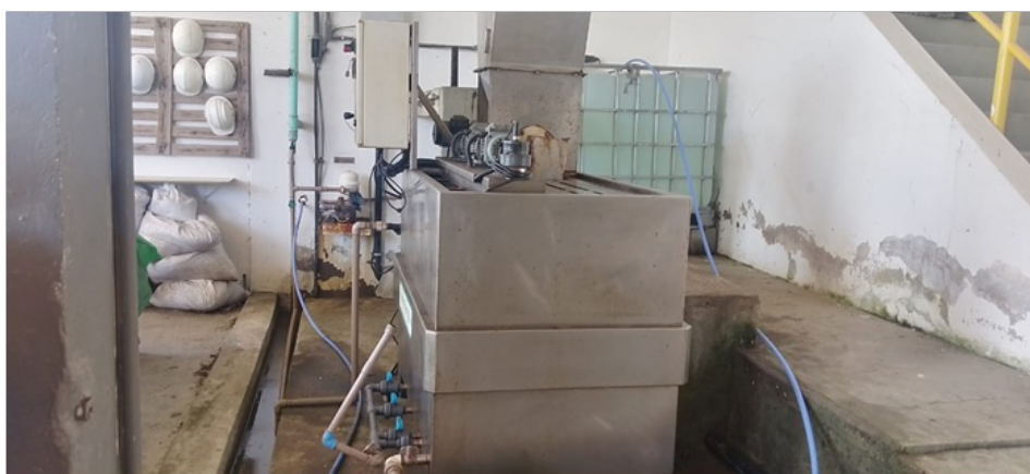
Foto11 – Unidade preparadora de polímero para floculação do lodo
