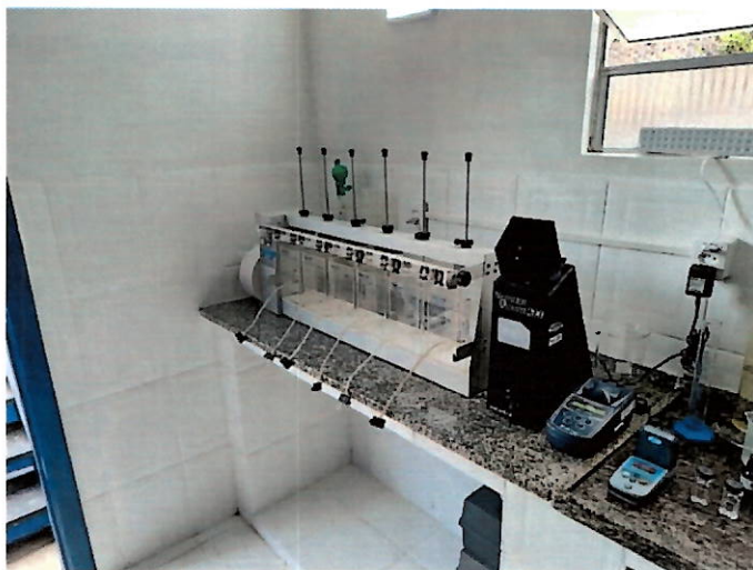
Foto 12 – Laboratório com JAR teste e medidores de turbidez e pH.
