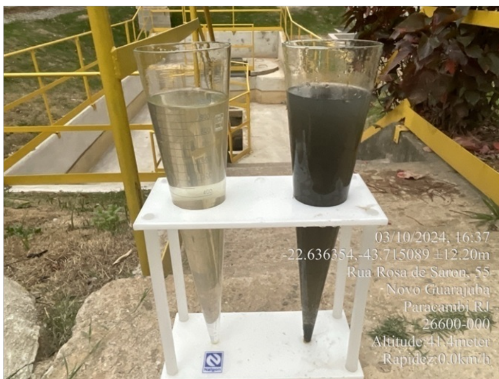
Foto 11 – Comparação entre esgoto clarificado e bruto.
