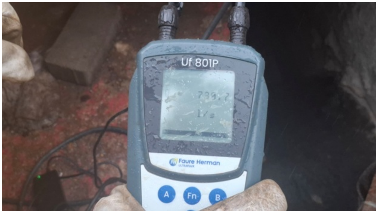
Foto 24 – Medidor de vazão medindo 739,7 litros por segundo
