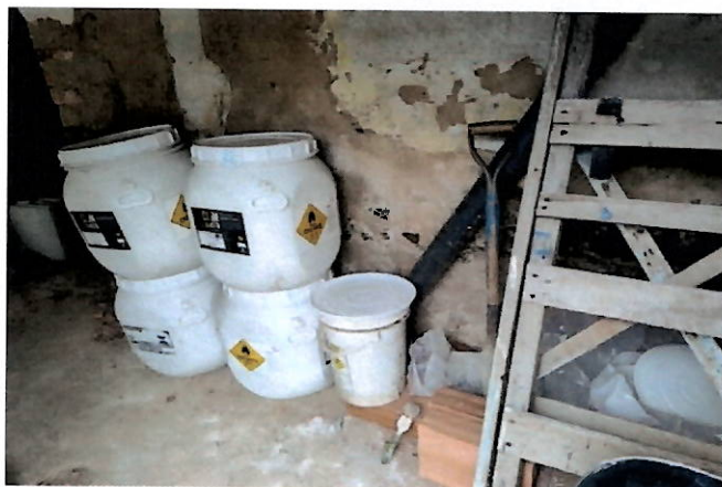
Figura 10- Armazenagem de pastilhas de Hipoclorito de Cálcio.
