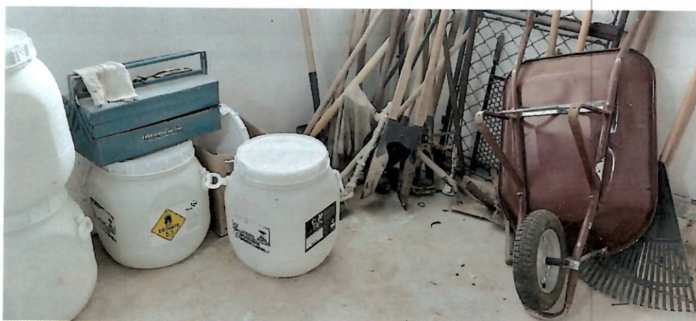
Figura 13- Armazenagem de pastilhas de Hipoclorito de Cálcio (acondicionamento inadequado de materiais).
