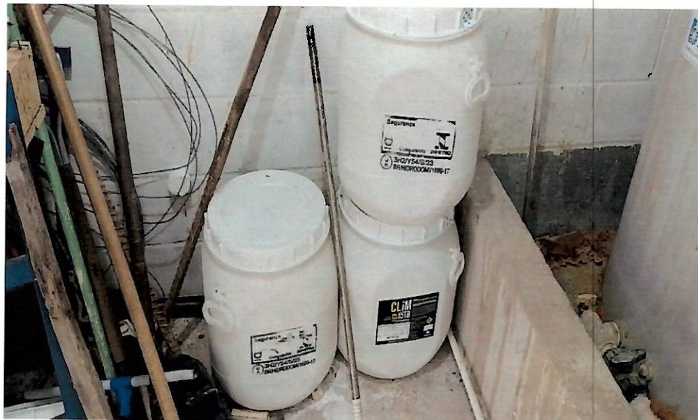
Figura 12- Armazenagem de pastilhas de Hipoclorito de Cálcio (acondicionamento inadequado de materiais).
