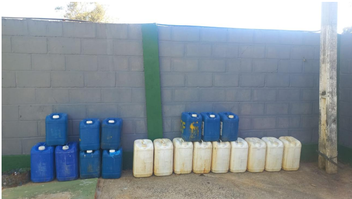
Foto 09 - galões diretamente no piso e sem contenção
