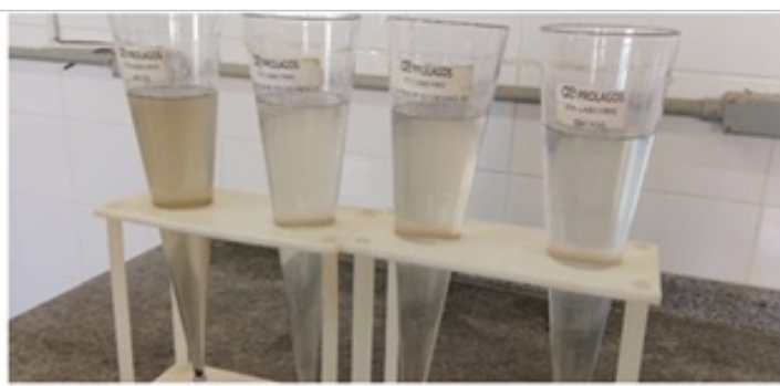
Foto 2 e 3 – Laboratório e cones ( onde se verifica que o esgoto bruto é muito diluído).
