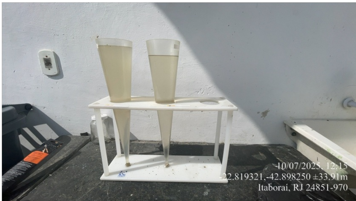
Foto 12 - Teste Imhoff do efluente.
