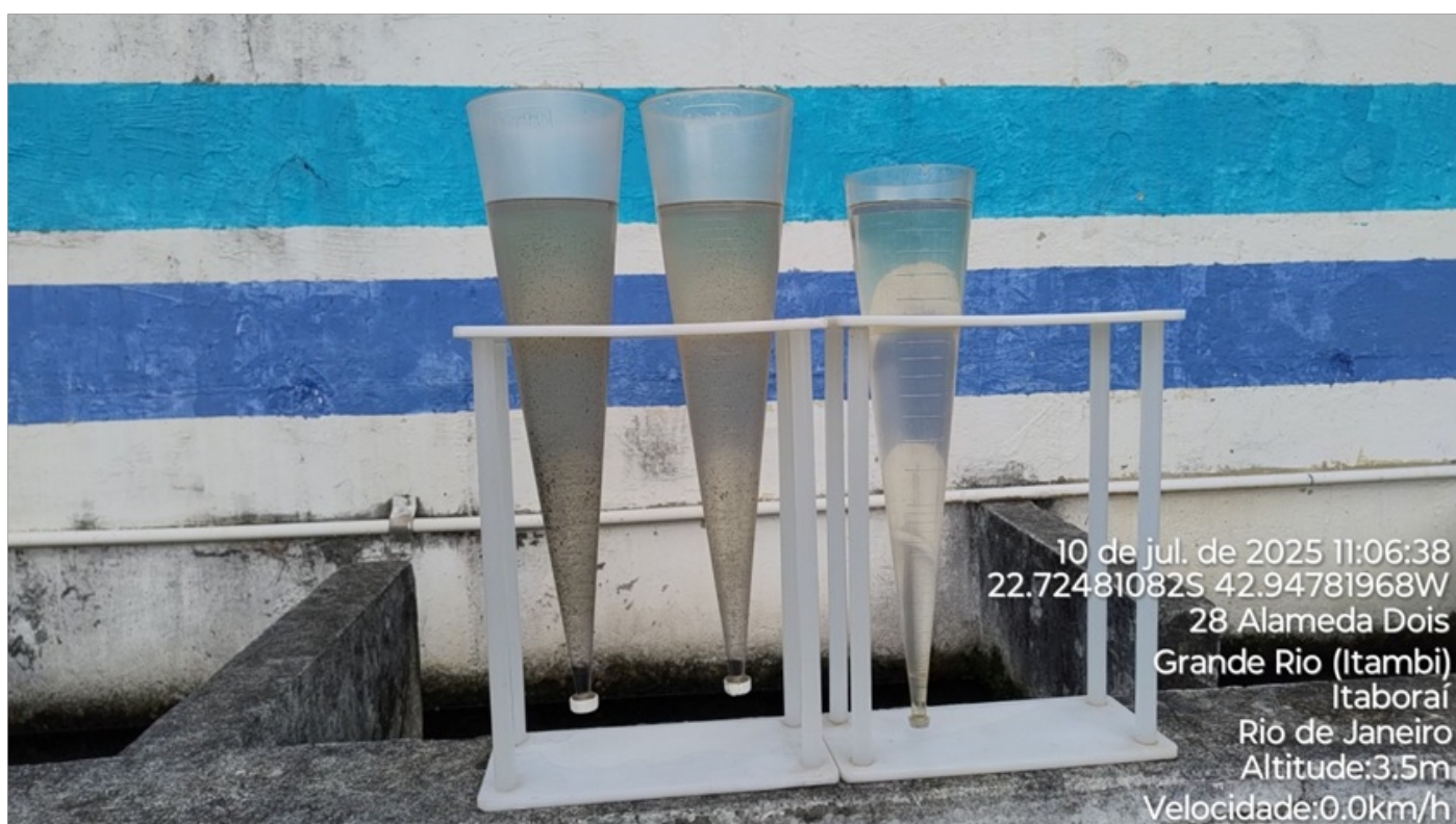
Foto 15 - Teste Imhoff do efluente de entrada e de saída.
