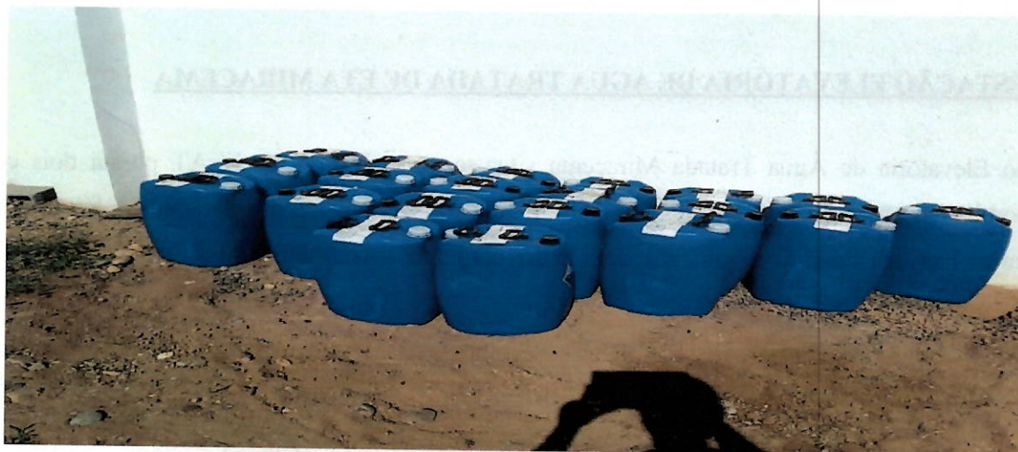
Foto 20 – Armazenamento inadequado de Sulfato de Alumínio.
