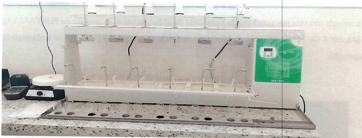
Foto 15 – Laboratório de monitoramento da água bruta onde é realizado o ensaio de jar-test.
