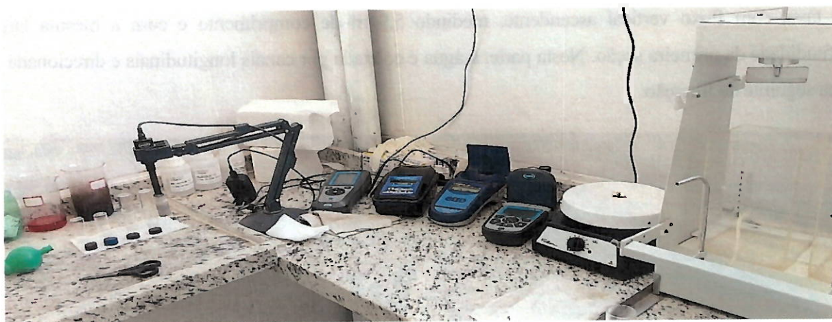
Foto 14 – Equipamentos de medição de parâmetros de potabilidade.
