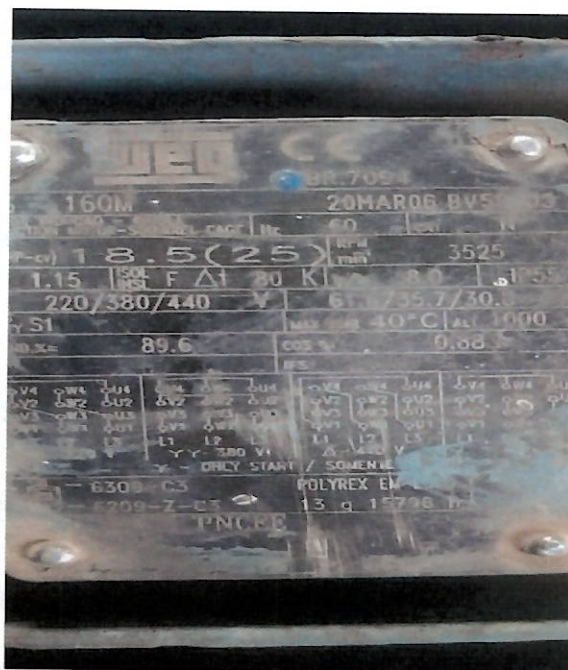
Figura 48 – Conjunto motobomba com potência 25 cv.
