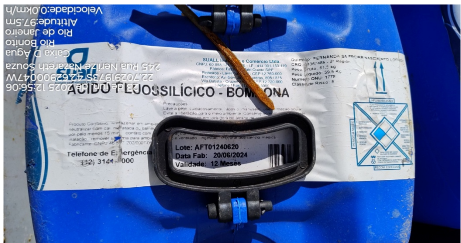
Foto 20 – Bombona de ácido fluossilícico (H 2 SiF 6 ) com validade vencida, além de exposição direta a radiação solar
