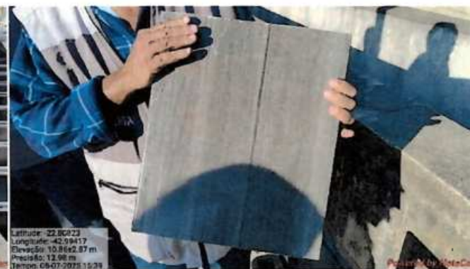
Foto 48: Chicana de Plástico Reforçado com Fibra de Vidro (PRFV) utilizada.
