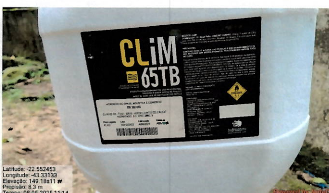
Foto 12: Hipoclorito de Cálcio utilizado na pré-cloração (produto dentro do prazo de validade).
