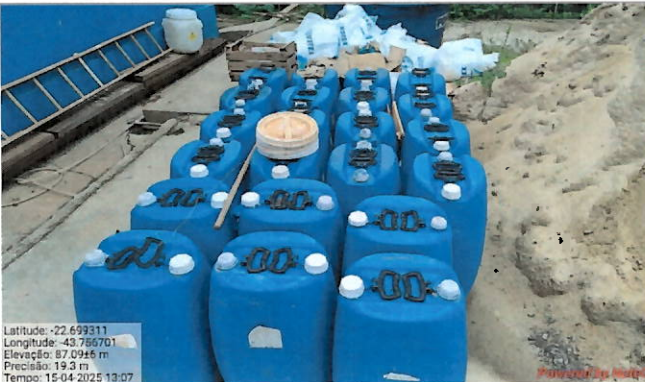
Foto 25: Armazenamento inadequado de bombonas de soda cáustica.
