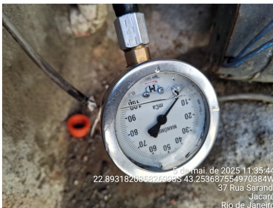
Foto 7 – Manômetro marcando 3 mca
