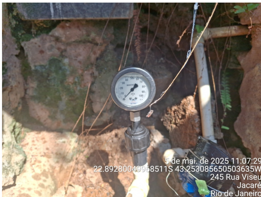
Foto 4 – Manômetro marcando menos 1 mca
