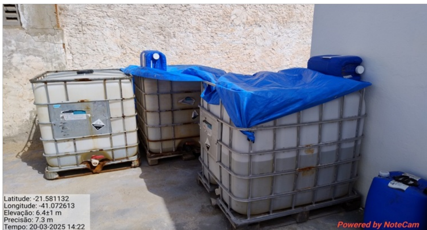
Foto 9 - Armazenamento de hipoclorito de cálcio
