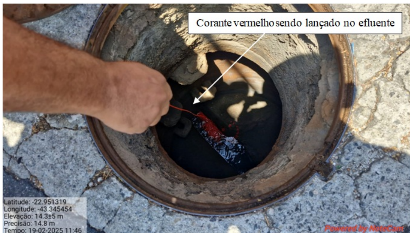
Foto 03 – Teste do corante feito no PV em frente a Empresa RICA e ao imóvel nº 450 da Estrada Caribú
