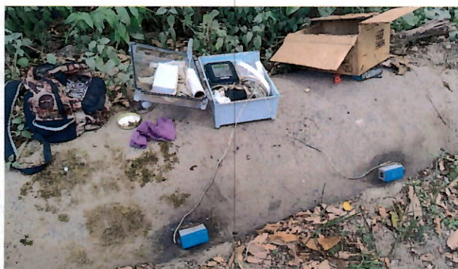
Foto 24: Ponto de medição de vazão (medidor ultrassônico).
