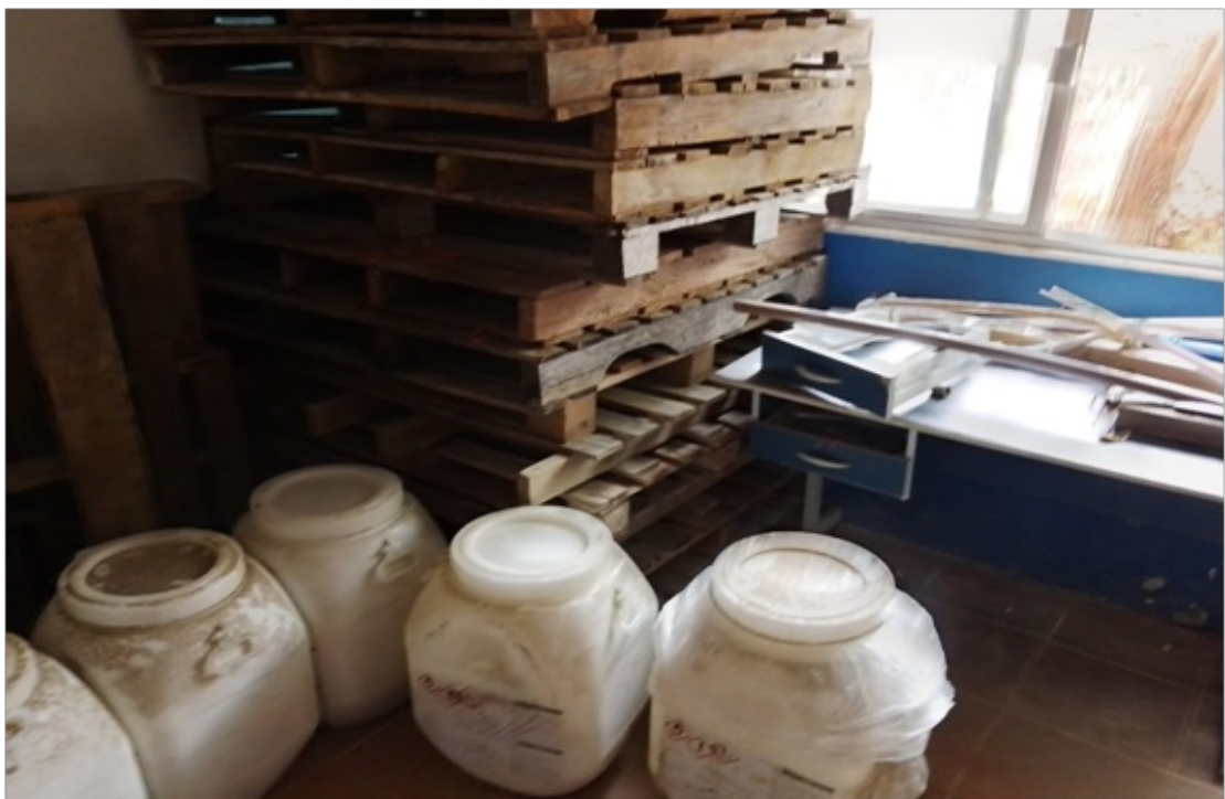
Foto 18 – Armazenamento de hipoclorito de cálcio deve-se manter afastado de roupas/de outros materiais combustíveis (NR 20/ Ministério do Trabalho e Emprego;
