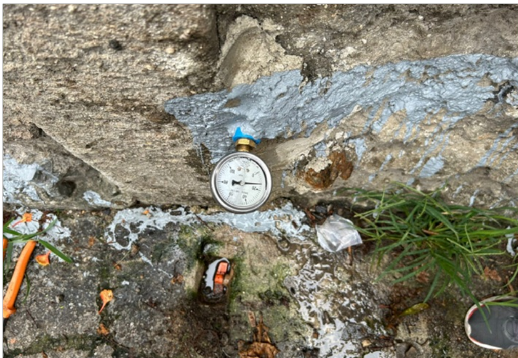
Foto 12 - Ponto de monitoramento da pressão manométrica do logradouro medindo 13 MCA
