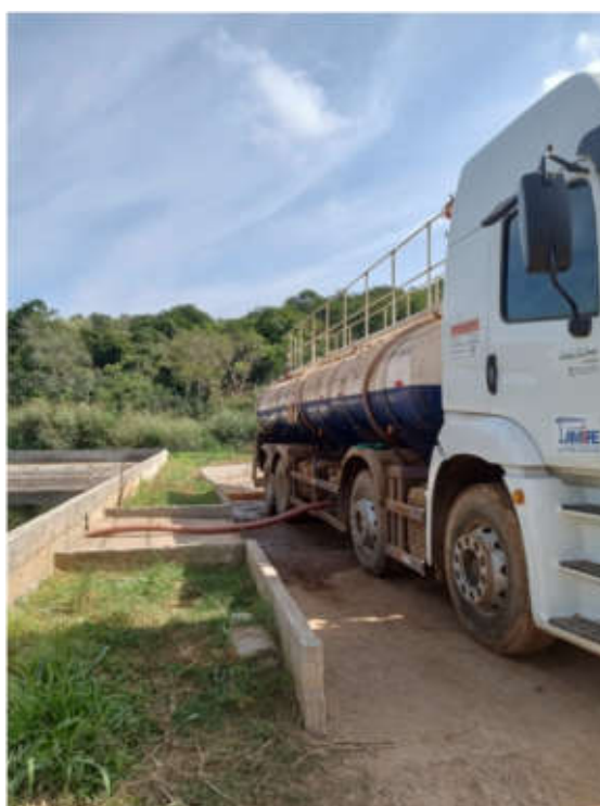
Figura 38: Caminhão coletando chorume.
