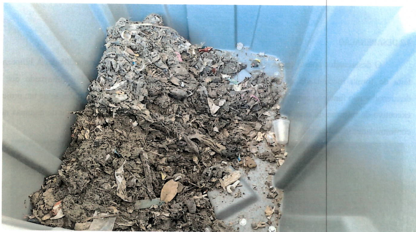
Foto 6 - Resíduos sólidos retirados no gradeamento.
