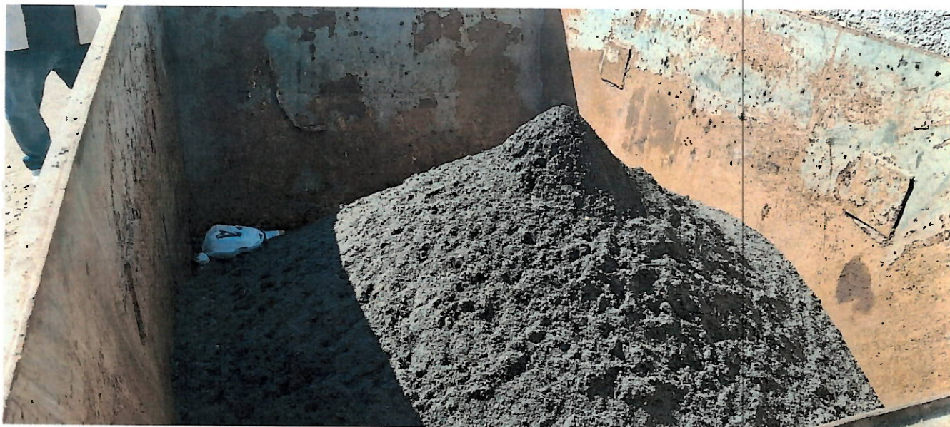
Foto 13 - Vista da caçamba de acúmulo dos sólidos retirados na desarenação.
