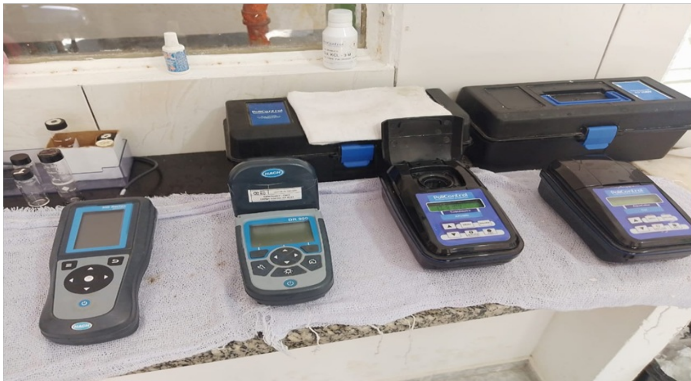
Foto 12 - Equipamentos de medição de parâmetros de potabilidade.
