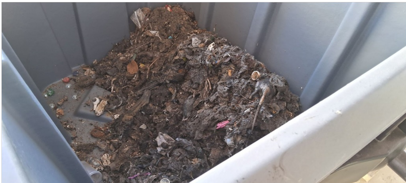
Foto 3 - Resíduos retirados no gradeamento.
