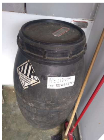
Placas de Identificação de Produtos Químicos inadequada
