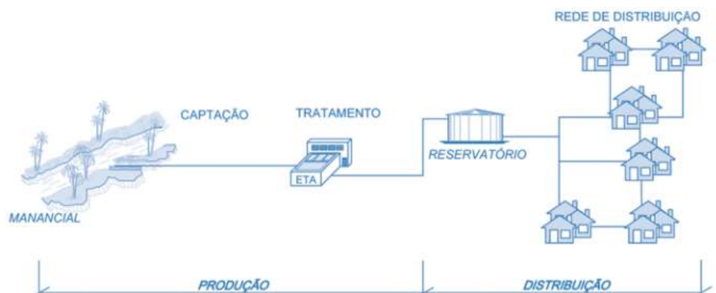
Figura 2 – Esquema Simplificado de um Sistema de Abastecimento
