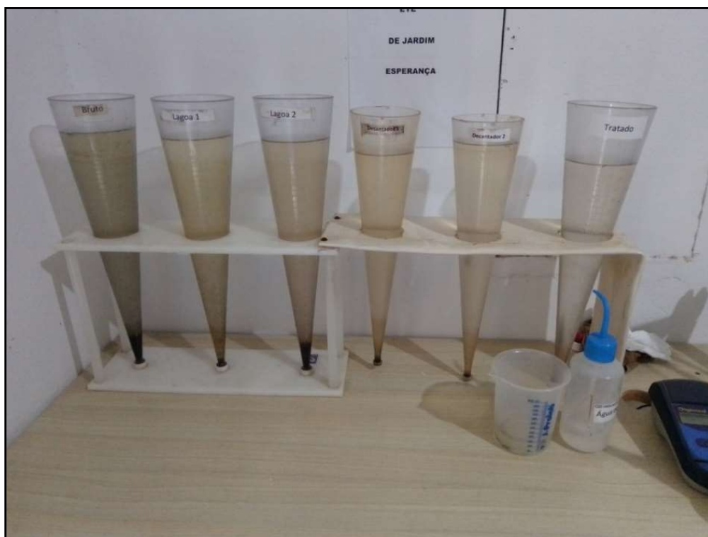
Figura 12 – Amostras no laboratório do efluente de cada etapa do tratamento (mais clarificado da esquerda para a direita, ou seja, de montante para jusante da ETE)
