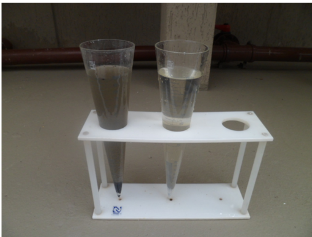
Foto 25 – Amostras do Esgoto In Natura e Tratado
