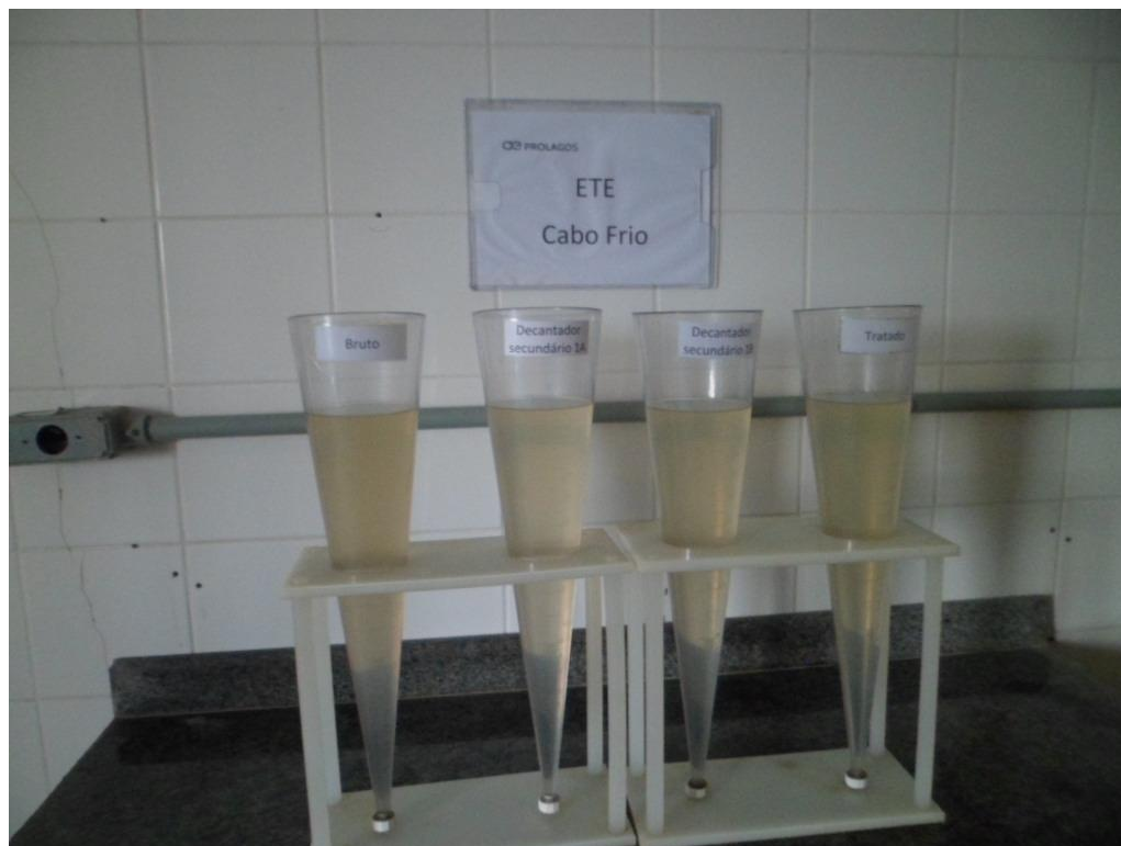
Foto 21 – Amostras dos Esgotos da ETE (Bruto, Decantadores e Tratado)
