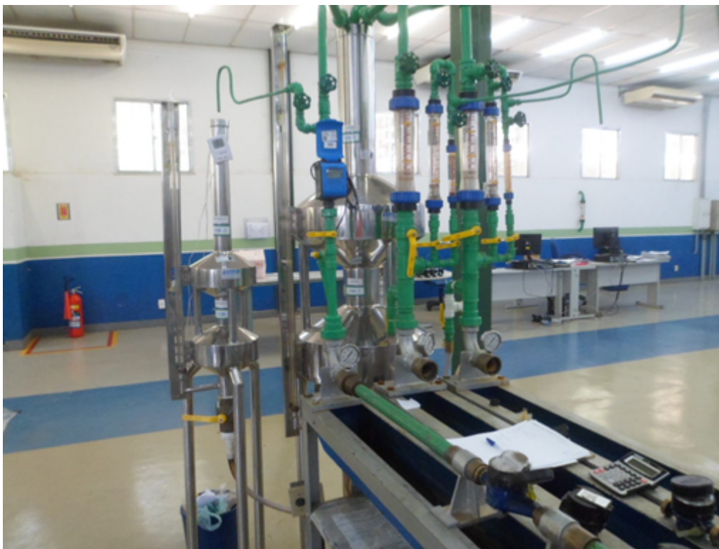
Foto 10 – Hidrômetro na bancada sendo testado
