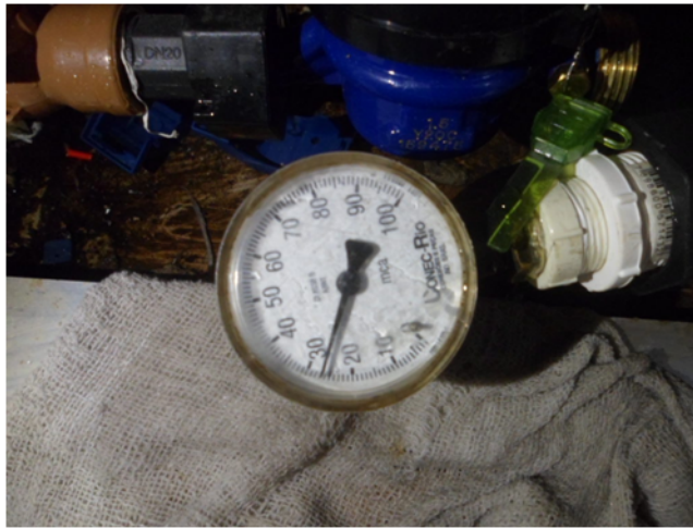
Foto 08 – Manômetro Marcando 27 M.C.A (Metros de Coluna D'água) Loja 2191A
