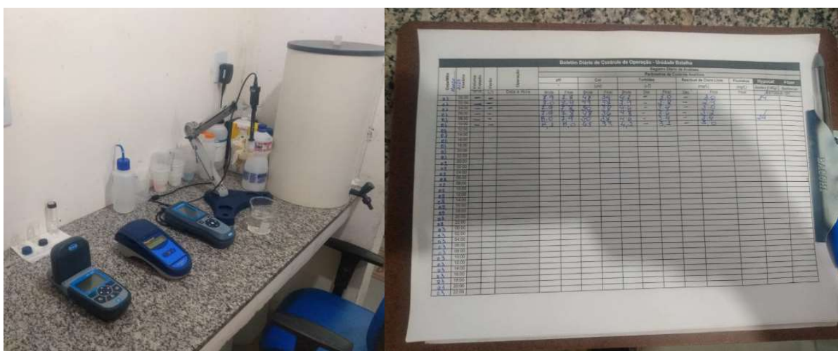
Aparelhos para fazer análise dos parâmetros físicos e químicos da água bruta e planilha com os resultados das amostras coletadas no dia
