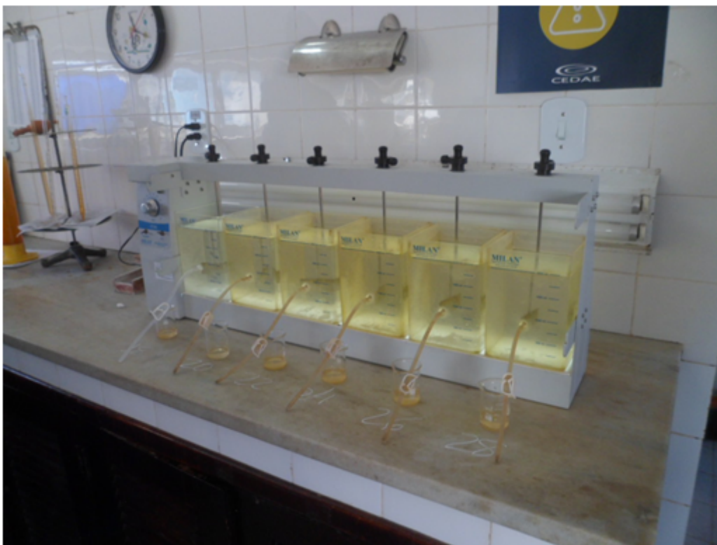
Foto 08 – Equipamento de Controle Jar Test (Medidor de Dosagem de Coagulante/Floculante)
