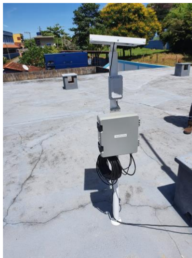
Sensor de nível eletrônico alimentado por placa solar.
