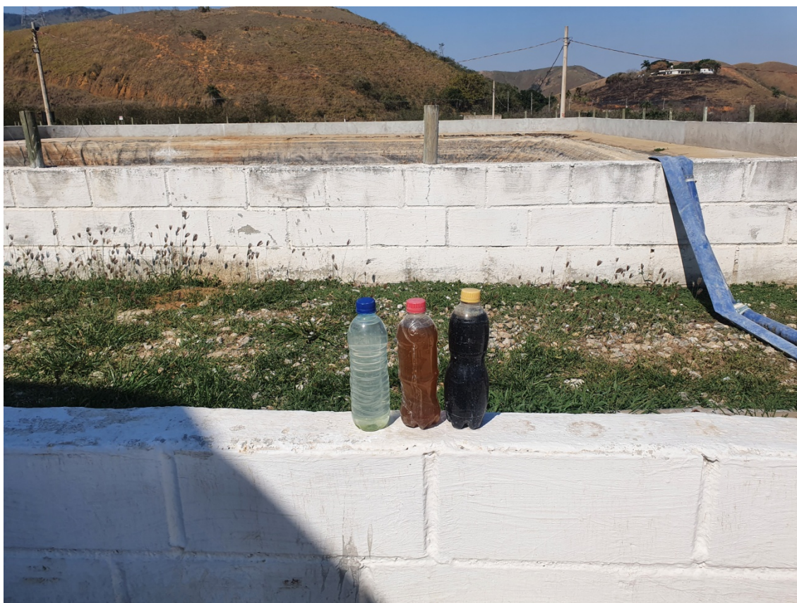
Figura 09: água de proveniente do tratamento do chorume.
