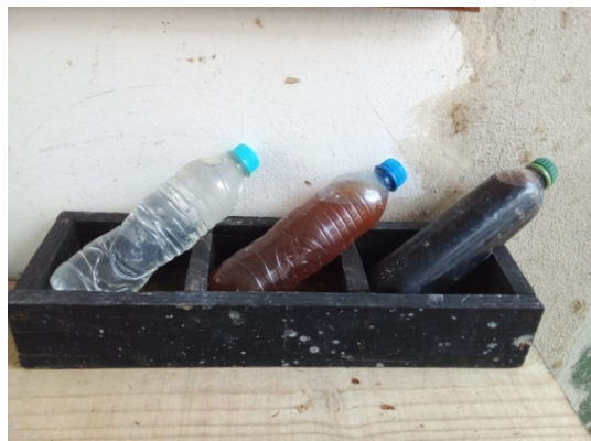
Figura 16: Comparativo em garrafas entre o efluente antes, durante e após o tratamento
