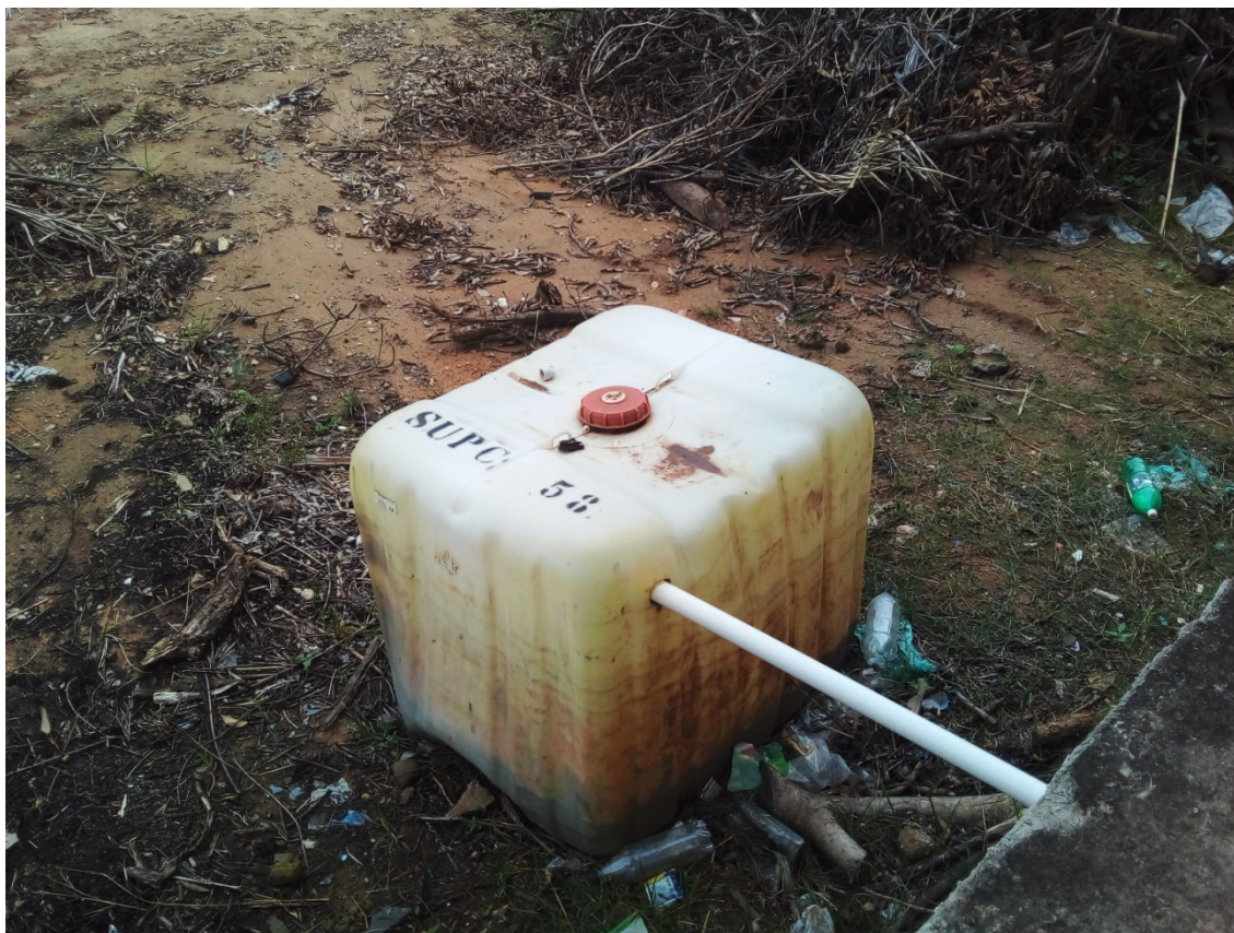
Figura 14: Tanque de armazenagem de bio fertilizante
