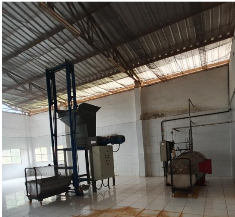
Figura 16: Autoclave disponibilizada para realizar o tratamento de RSS. Inoperante.
