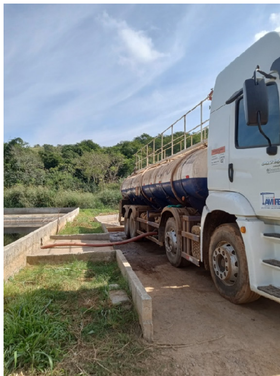
Figura 16: Caminhão coletando chorume.
