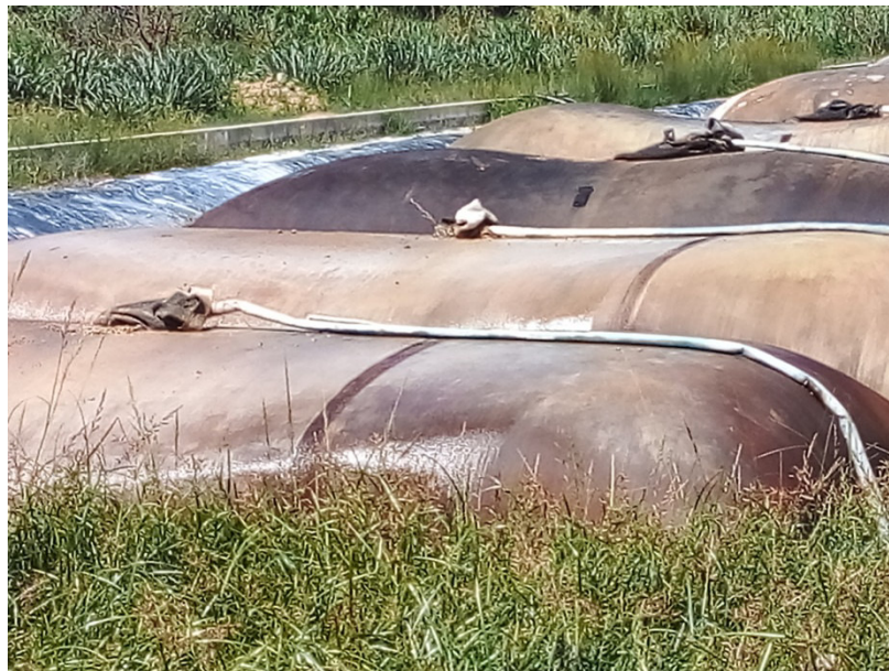
Figura 25: Bags de armazenagem e secagem do lodo
